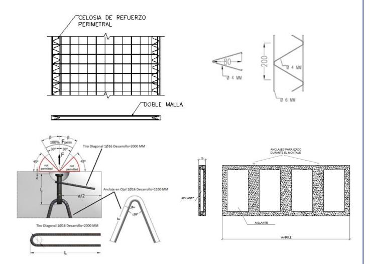
Datos técnicos para paneles de espesor 16 cm aligerado "tipo".
